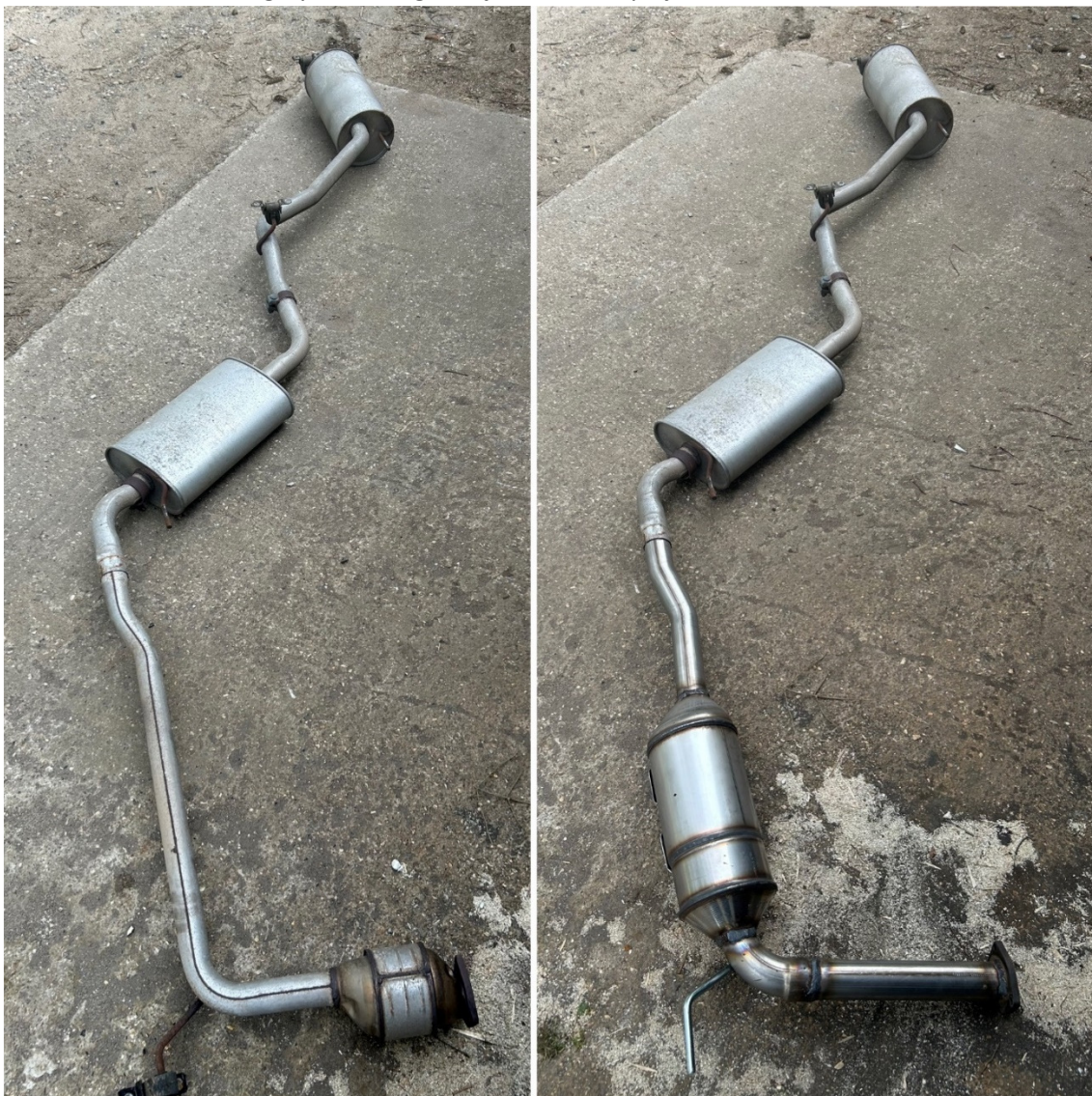
Komplet udstødningssystem på jorden. Med original katalysator (venstre) og med DPF (højre)
